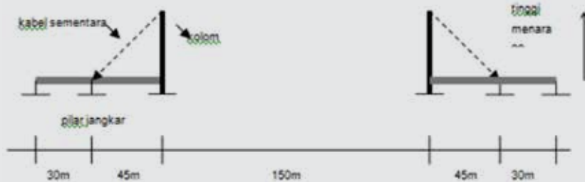
Gambar 30 Skema pemasangan kolom menara
