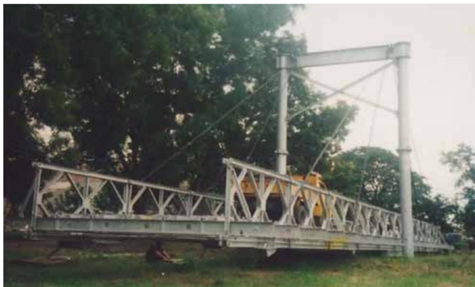
Gambar 35 Pengujian beban-getar prototipe Jembatan Bailey modifikasi kabel
