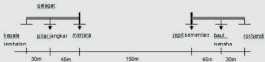
Gambar 29 Skema pemasangan gelagar tepi
