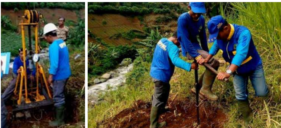
Gambar 4.3 Contoh pelaksanaan penyelidikan tanah dengan alat sondir
