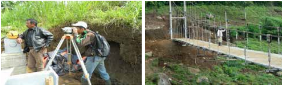
Gambar 4.21 Pemeriksaan Camber Jembatan
