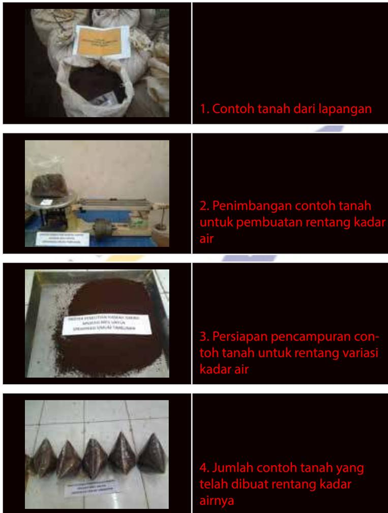
**Gambar 3-3: Persiapan Contoh untuk Pengujian MCV**
