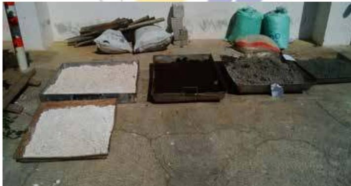
**Gambar 5-12: Pengeringan Contoh Tanah dengan Cara Dijemur Matahari Setelah Perendaman**
