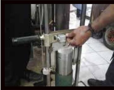
3. Palu bagian bawah secara hati-hati diletakkan pada piringan fiber dan diijinkan masuk kedalam cetakan, penetrasi terjadi akibat berat sendiri serta penghitung pukulan menunjukkan angka nol
