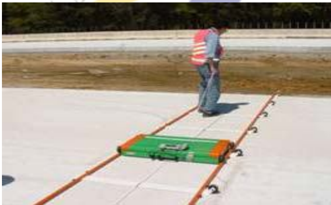
Gambar 19. Tipikal pendeteksian MIT Scan-2 di lapangan
