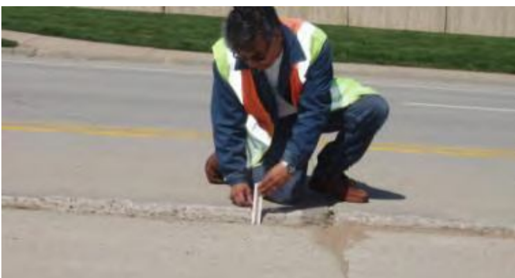
Gambar 23. Faulting pada sambungan memanjang
