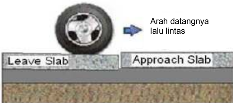
Gambar 6b. Sambungan tanpa dowel
