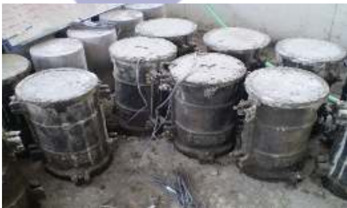
Gambar 33. Benda uji silinder yang telah di beri sensor di dalamnya
