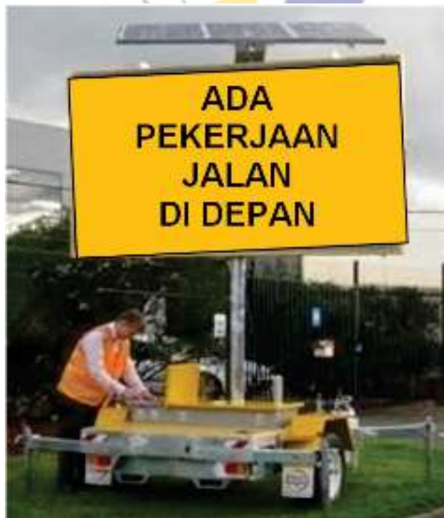
Gambar 3.11 Portabel DMS dan VMS yang bisa dipindah-pindah
