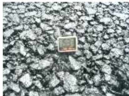
Gambar 28. Pengukuran temperatur campuran ATPB pada saat percobaan.
