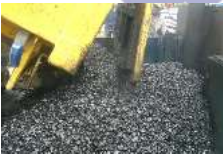
Gambar 27. Percobaan ATPB, kadar aspal modifikasi 4,0%. Agregat terselubungi aspal merata. Campuran homogen, tidak segregasi.
