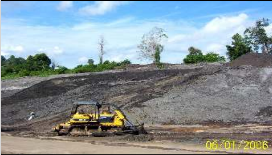
Gambar 2.1. Penambangan Asbuton Secara Terbuka
