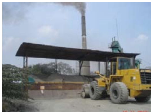
Gambar 3.2 Pengisian Bin Dingin Memakai Wheel Loader
