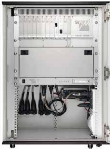
Gambar 3.19 Detail komponen data logger box sistem SiWIM
