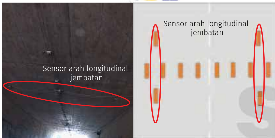
Gambar 5.6 Sensor arah longitudinal jembatan pada jembatan box culvert
