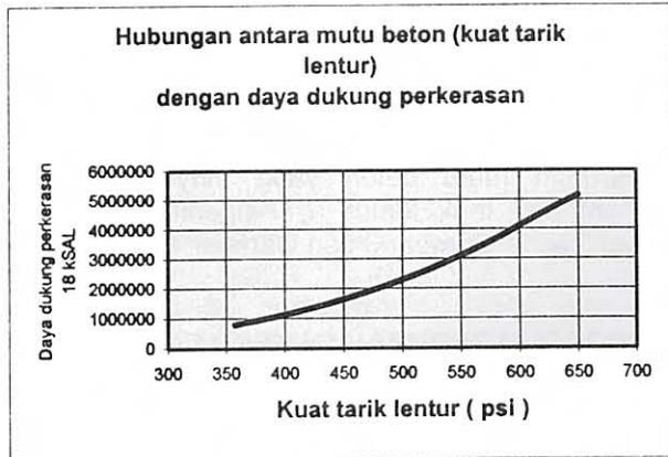
Gambar 3. Grafik kekuatan daya dukung perkerasan dengan mutu beton ( kuat tarik lentur)
