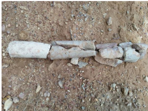
Gambar 12. Kondisi pengambilan sample untuk penentuan RQD
