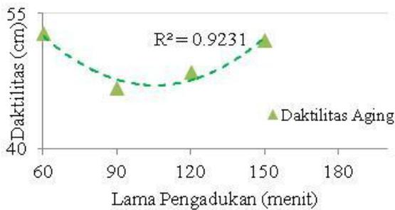
**Gambar 10.** Daktilitas setelah *TFOT*, temperatur pencampuran 170 °C
