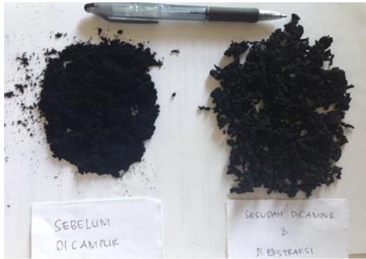
**Gambar 2.** Adanya perubahan bentuk pada CR yang dicampurkan aspal
