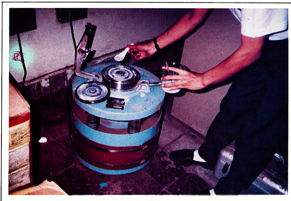
Gb. 2. Alat Vibration Mill T – 100 untuk menumbuk contoh berbutir
