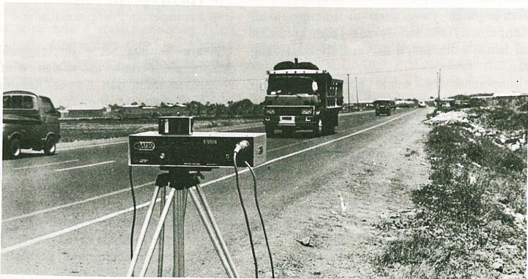
Contoh Pengukuran Kecepatan dari Bahu Jalan Raya
