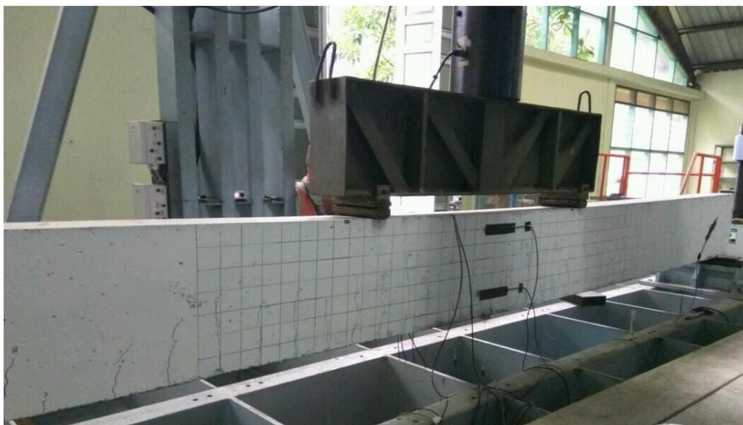
**Gambar 7.** Uji lentur struktur balok beton bertulang
