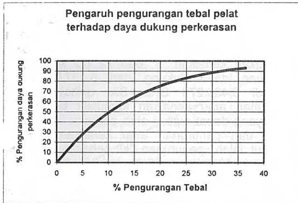
**Gambar 2. Grafik pengaruh % pengurangan tebal pelat terhadap daya dukung perkerasan**
