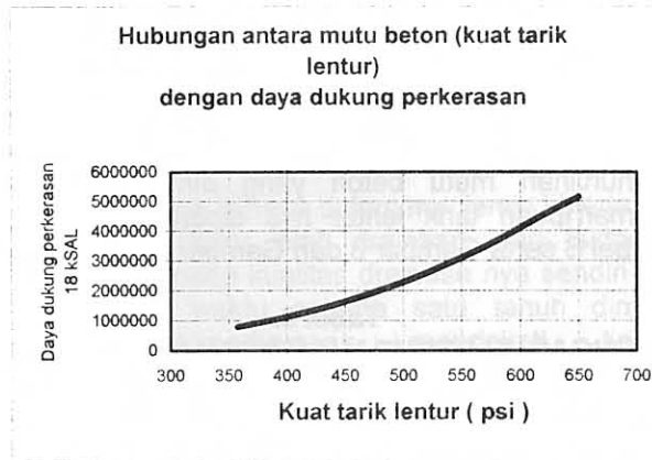
Gambar 3. Grafik kekuatan daya dukung perkerasan dengan mutu beton ( kuat tarik lentur)
