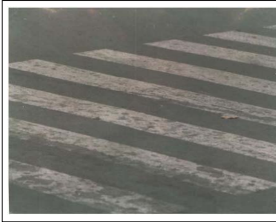
Gambar 3. Pengamatan pada umur 7 bulan dengan tingkat keausan 50%
