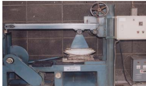
Gambar 5a. Alat pemadat dan pencampur untuk pembuatan benda uji Wheel Traking
