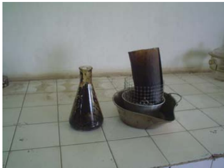
Gambar 4. Pengujian kelarutan bitumen dari asbuton butir
