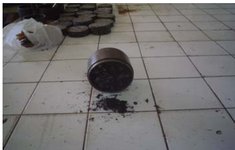
Gambar 7. Lepasnya campuran setelah pemadatan Marshall
