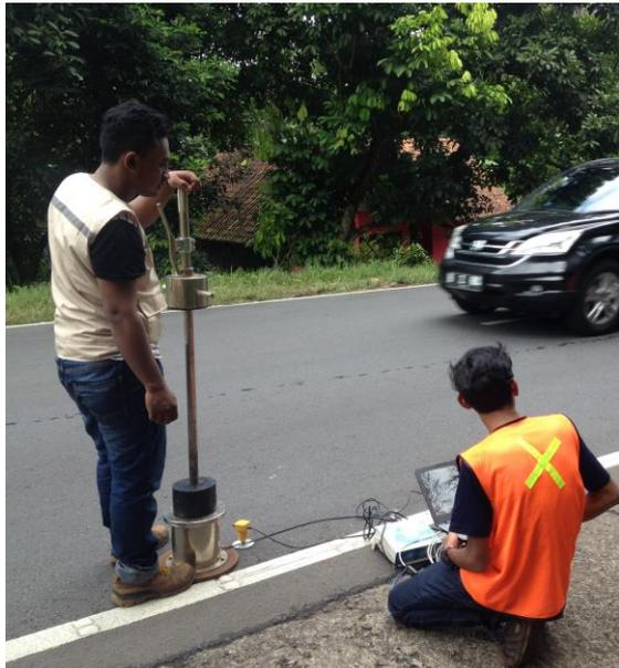
**Gambar 1.** Satu unit *LWD* Pusjatan dalam pengoperasian di jalan beraspal
