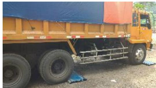
**Gambar 7.** Truk uji yang digunakan untuk keperluan kalibrasi (Nugraha dan Sukmara 2016)
