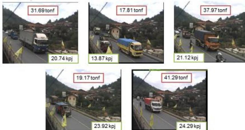
**Gambar 13.** Hasil perhitungan beban total kendaraan dan kecepatan kendaraan dari *bridge WIM*
