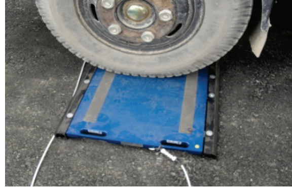
Gambar 8. Penimbangan beban truk uji
