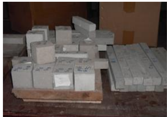
Gambar 5. Benda uji kubus mortar
