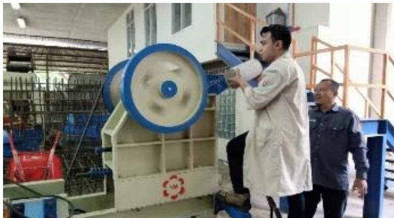
Gambar 3. Penghancuran limbah beton menggunakan *stone crusher*
