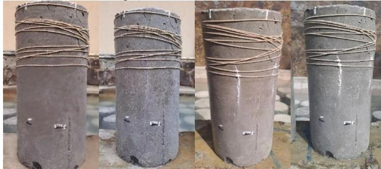
Gambar 7. Pengamatan *self-healing process* pada sampel beton 28 hari sampai hari ke-28
