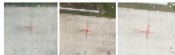
Gambar 6. Kualitas data mentah foto dari 3 PUNA: Phantom 4 Pro; Mavic 3E; WingtraOne Gen II
