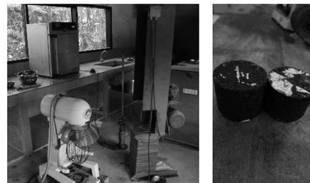
**Gambar 2.** (Kiri) Peralatan untuk Produksi Sampel dan (Kanan) Sampel Briket Aspal hasil produksi
