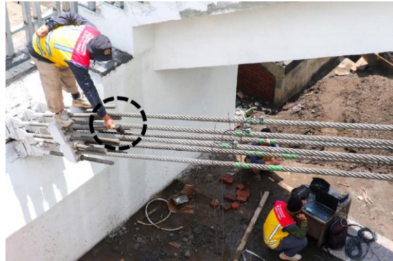
Gambar 7. Pengujian frekuensi getar kabel backstay dengan trigger getaran impact hammer
