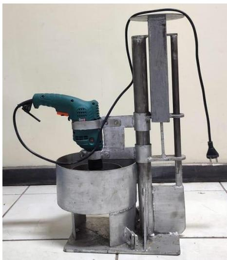
Gambar 3. Alat uji *ravelling*.
