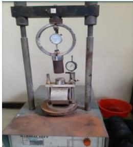
**Gambar 2.** Alat pengujian *Marshall*.
