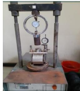
**Gambar 3.** Alat pengujian *Marshall*.
