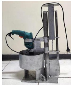
**Gambar 4.** Alat uji *ravelling*.
