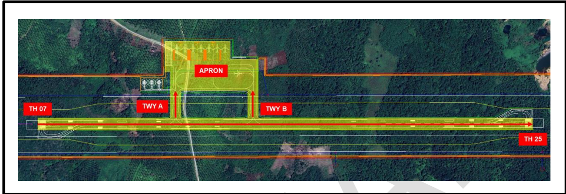
Gambar SKh.1.9.17.1) Layout Pengujian HWD di Runway dan Taxiway
