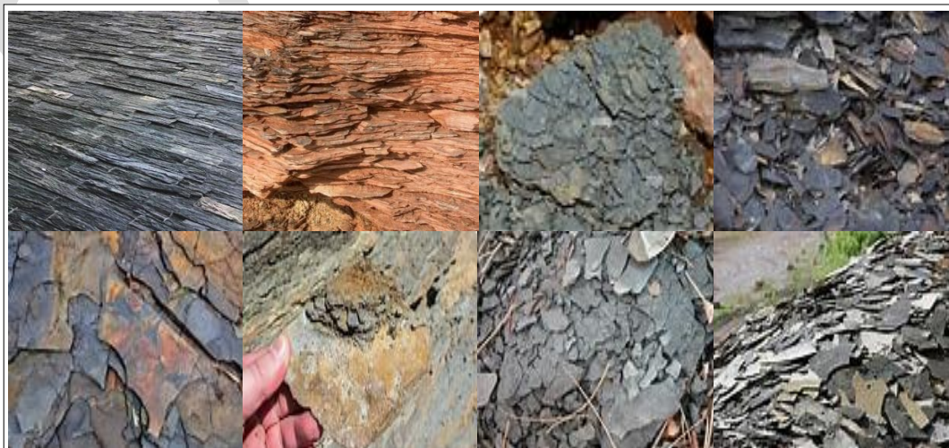
Gambar SKh.1.3.33.3) Tipikal Bahan Serpih Lapuk Sempurna
