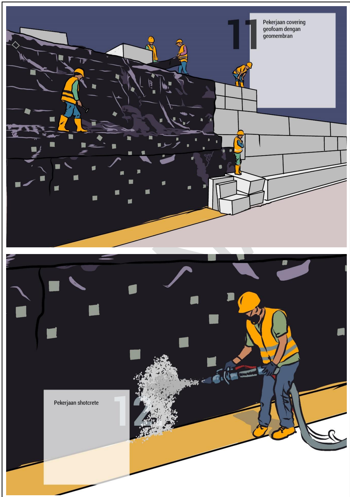
Gambar SKh.1.3.24.8) Ilustrasi Metode Pelaksanaan EPS Geofoam
