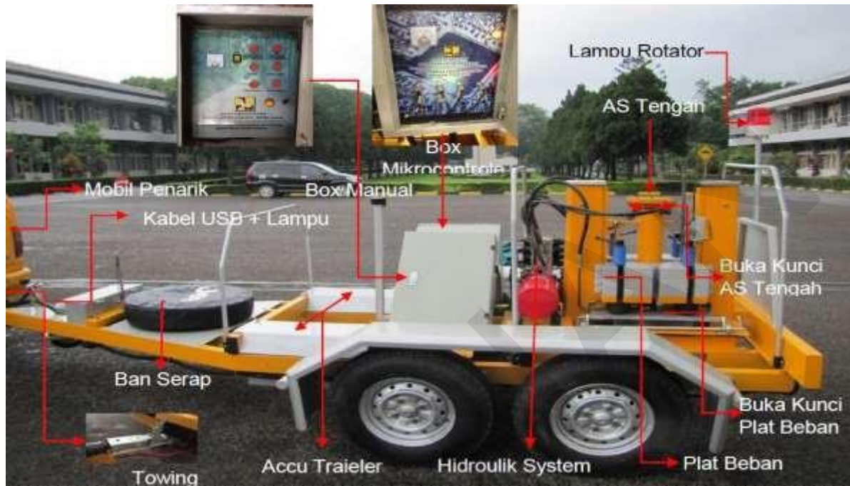
Gambar 6. Ilustrasi Komponen Alat Pengujian Kekuatan Jalan (APKJ)
