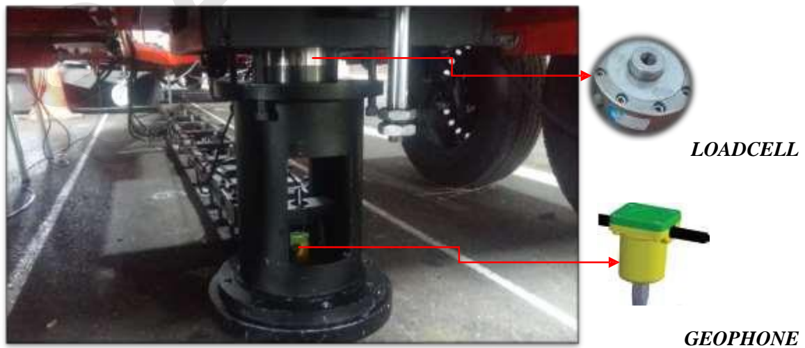
Gambar 10. Konfigurasi Loadcell dan Geophone APKJ
