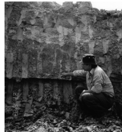
Gambar 46 Posisi retakan pada lereng bawah lokasi Cikampek (Dok : Alan Rachlan, 2003)
