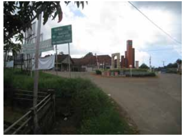
▲ Ujung pulau lain yang memisahkan persimpangan Y ini juga memiliki sebuah hazard sisi jalan dalam wilayah (gore area).
