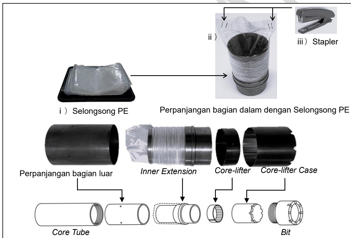
Gambar 14 - Pengaturan core-lifter dan selongsong PE
