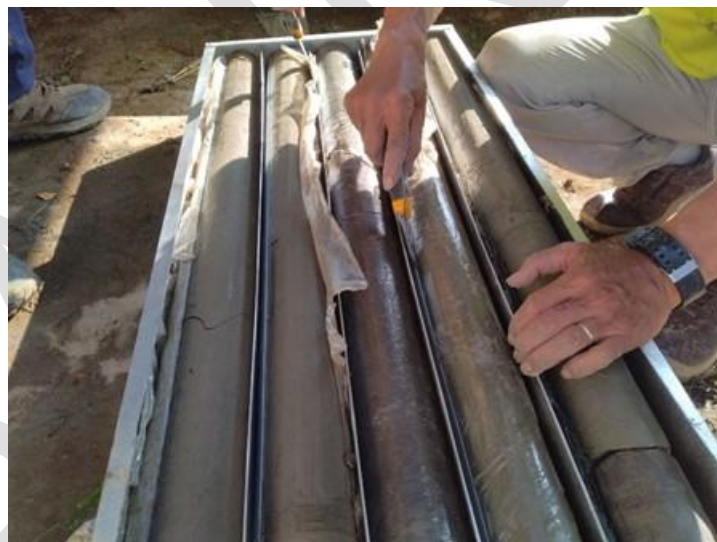
Figure 18 - PE sleeve stripping
