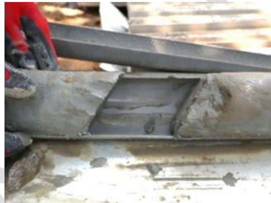
Konfirmasi bidang gelincir pada inti bor yang diambil dengan metode pengeboran hibrida
