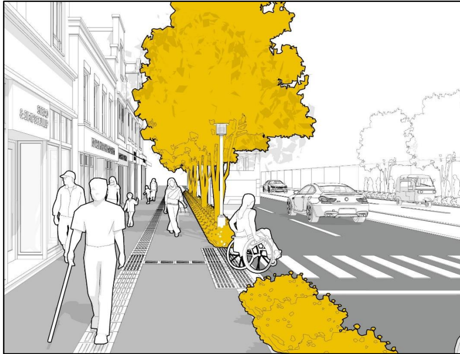
Gambar 1 - Ilustrasi gambar trotoar dengan ketinggian sama dengan badan jalan
