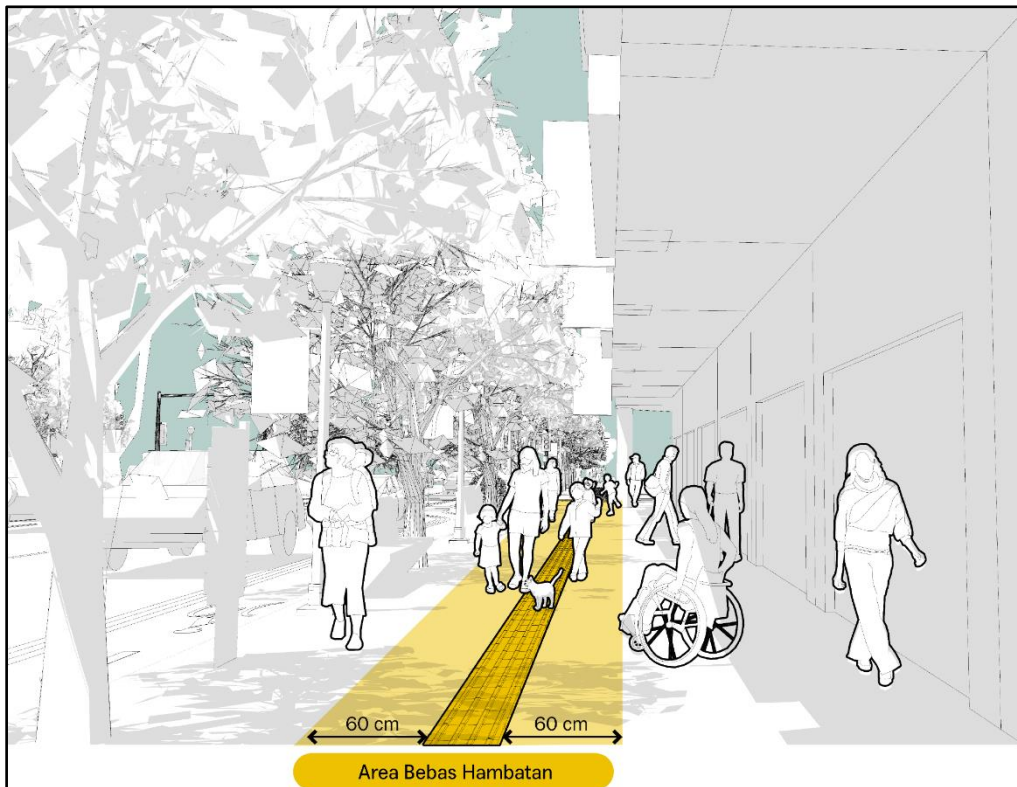
Gambar 21 - Peletakkan jalur pemandu pola garis pada trotoar
