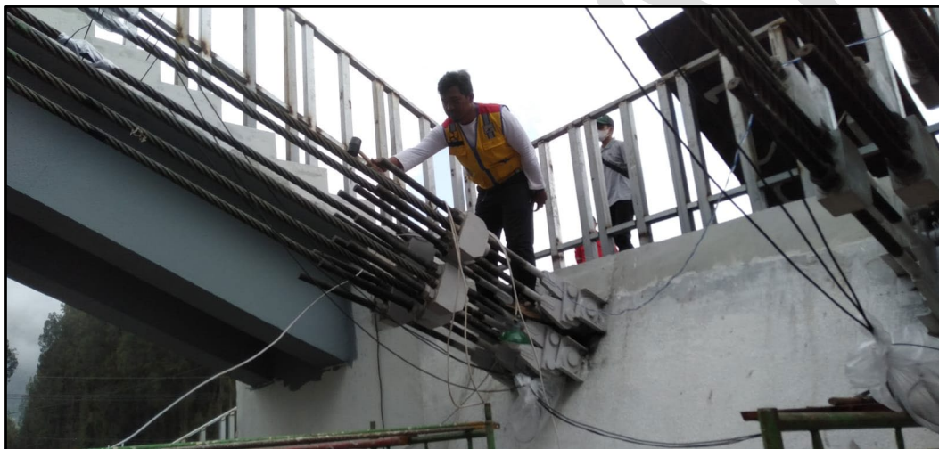
Gambar 18 - Pengujian gaya kabel jembatan
