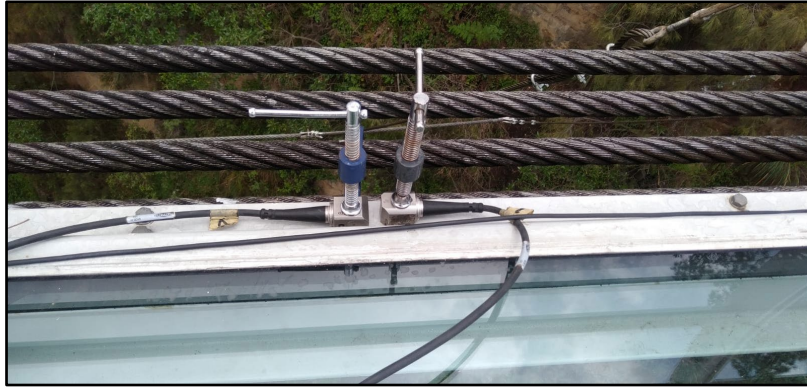
Gambar 15 - Sensor accelerometer pada pengujian dinamis jembatan
