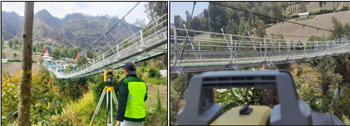
Gambar 12 - Pengukuran geometri jembatan dengan total station
