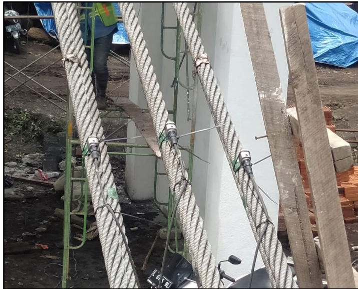
Gambar 17 - Pengukuran tegangan kabel backstayed dengan accelerometer
