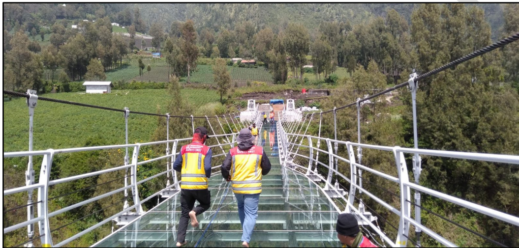
Gambar 16 - Pengujian dinamis dengan sumber gaya getaran orang berlari kecil/ jogging
