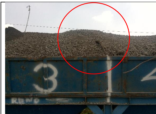
2.12 Side plate tidak mencegah kontaminasi
