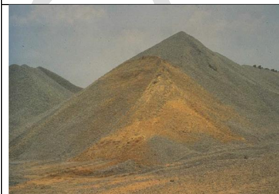
2.7 Kontaminasi stockpile dengan material di bawahnya
