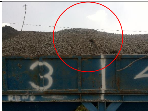
2.12 Side plate tidak mencegah kontaminasi
