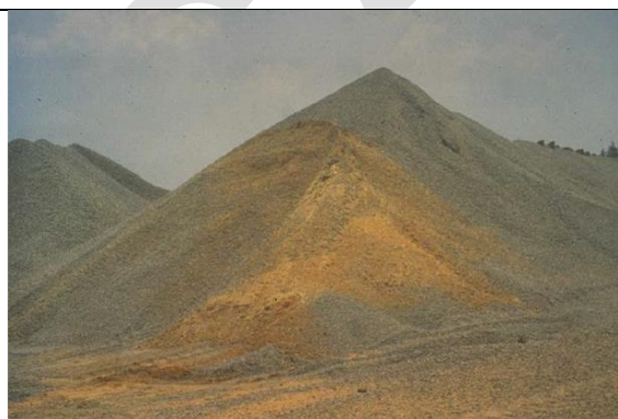
2.7 Kontaminasi stockpile dengan material di bawahnya
