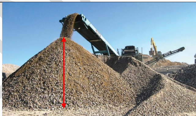
2.10 Ketinggian maksimum stockpile 5 m
