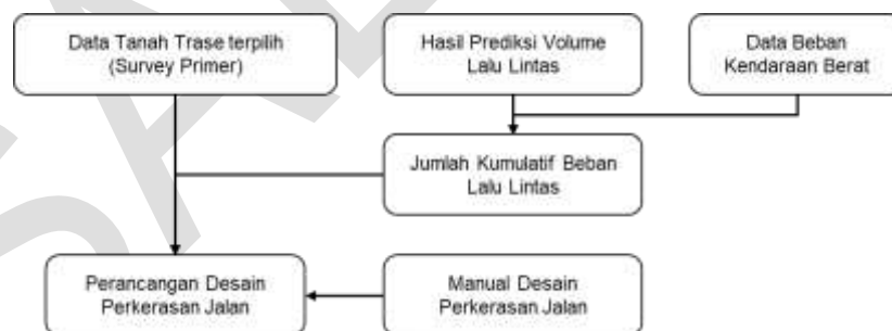
Gambar 12 - Bagan alir perancangan perkerasan jalan
