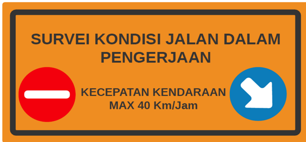
Gambar 27 – Rambu survei untuk pekerjaan survei IRI (penempatan bumper belakang kendaraan)
