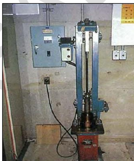
Gambar 90 – Marshall drop hammer (kiri) ; Marshall stability-flow apparatus (kanan)
