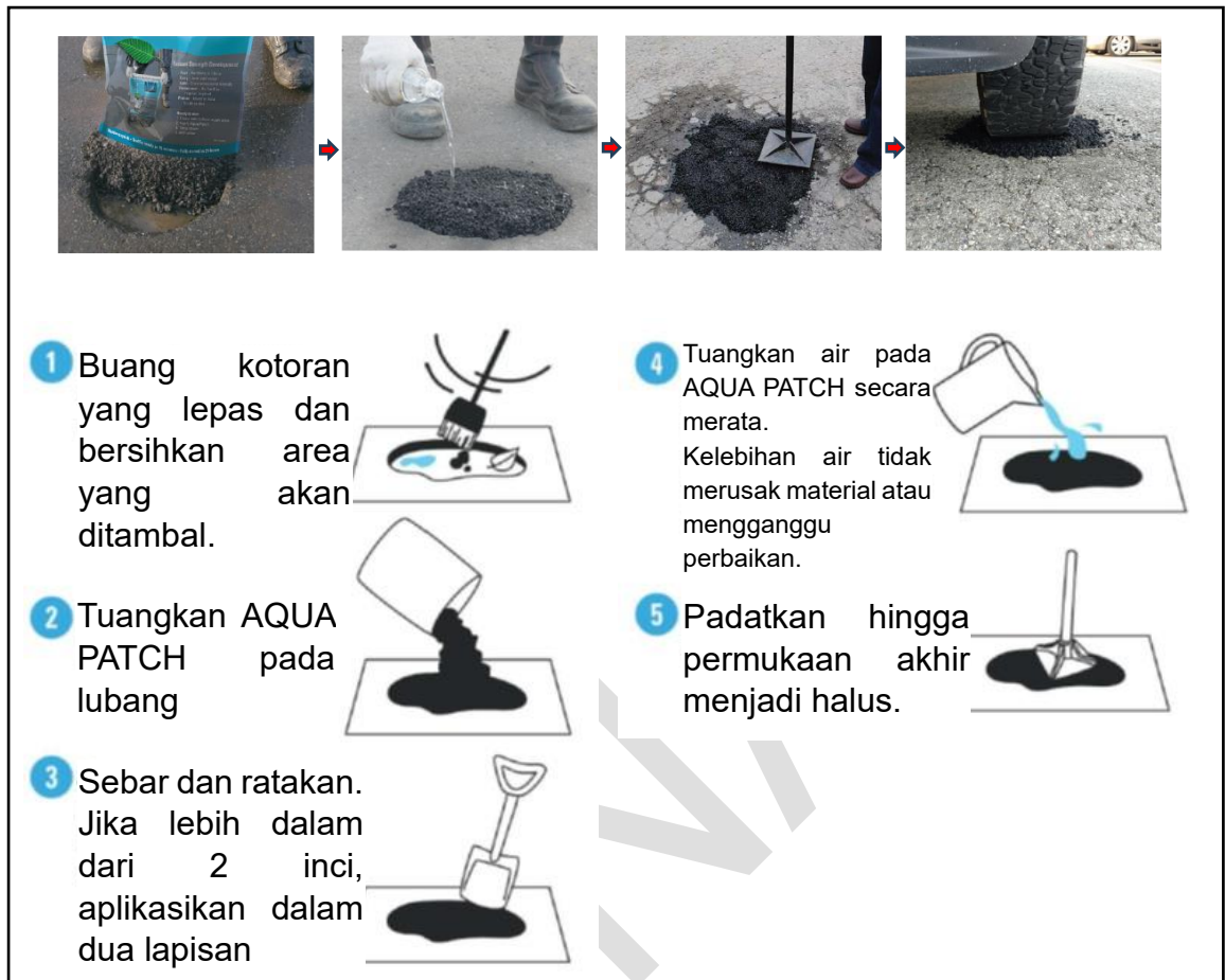
Gambar D - Prosedur kerja penambalan lubang dengan AQUA PATCH
