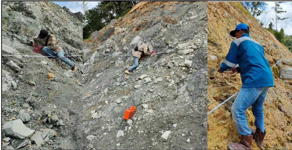
Gambar 3 – Contoh pengukuran dengan metode scanline
