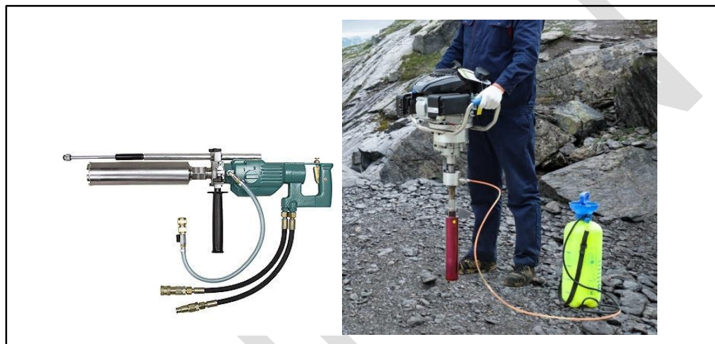
Gambar 5 – Alat pengeboran inti model genggam
