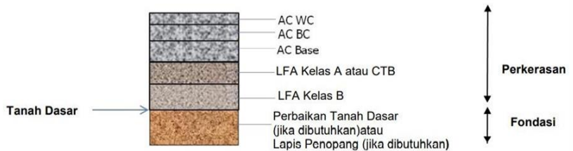
Gambar 3 - 1 Tipikal Perkerasan Lentur
