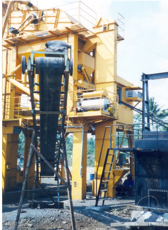
Gambar 19. Elevator Bahan Pengisi (Filler) Dengan Penimbangnya
