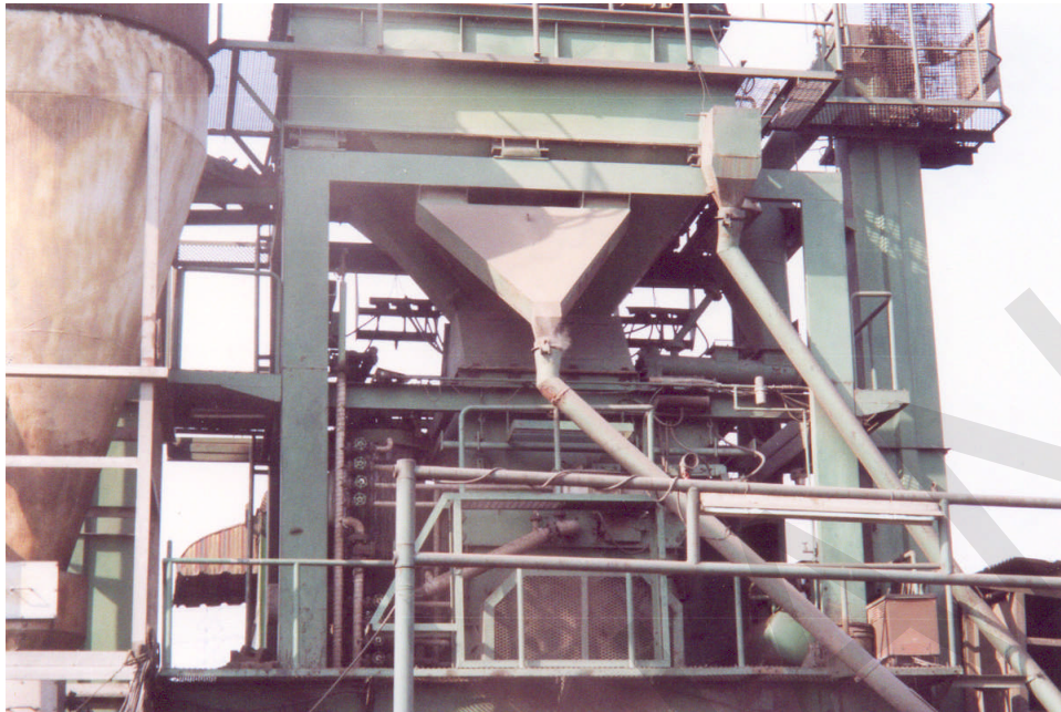
Gambar 14. Posisi Bin Panas ( Hot Bin ) dan Bin Penimbang ( Weigh Bin )
