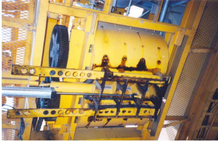
Gambar 18. Mekanisme Pembukaan/ Penutupan Pintu Pengeluaran dari Pugmill
