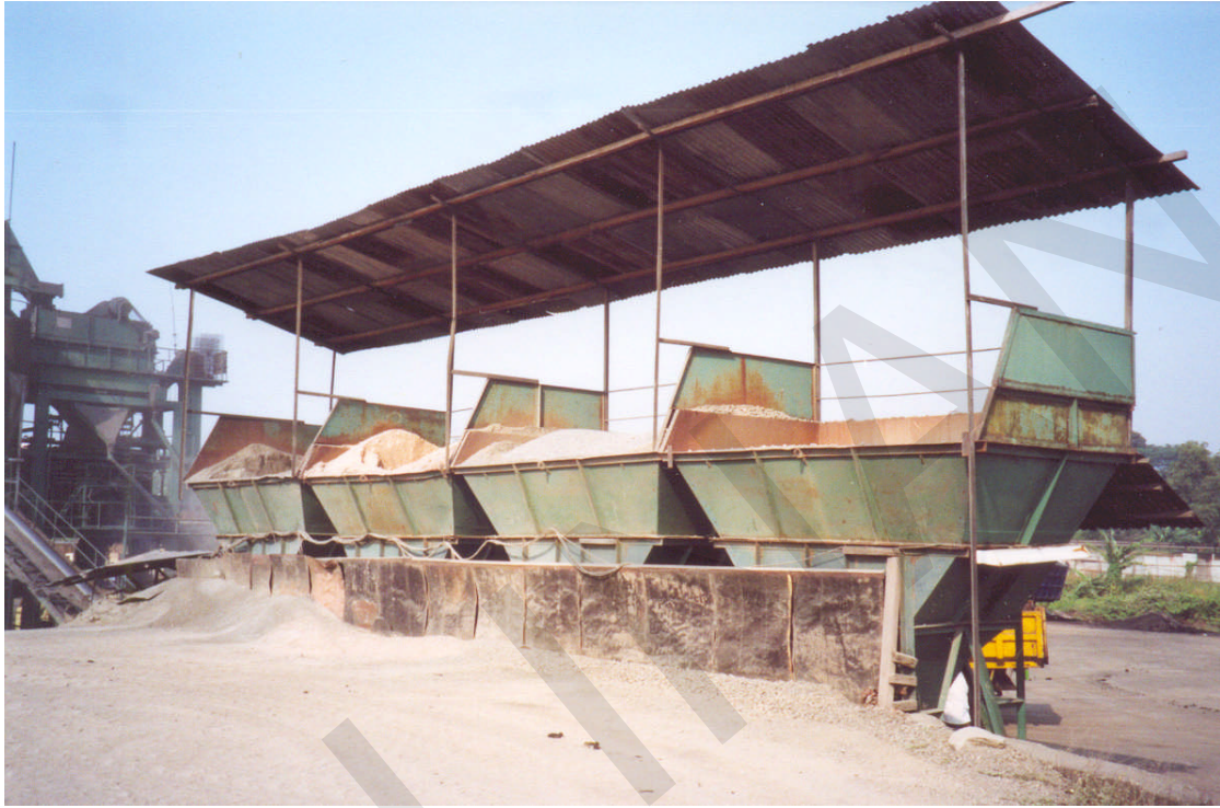
Gambar 1. Bin Dingin Dengan Dinding Penyekat
