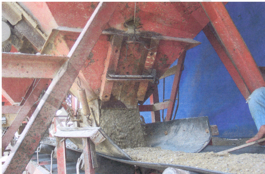
Gambar 3. Pintu Pengeluaran Agregat Dingin Sistem Pemeriksaan kelayakan Tinggi Bukaan
