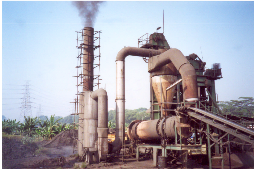
Gambar 24. Pengumpul debu ( dust collector ) Jenis Basah ( wet type ) terpasang pada AMP Tipe Batch
