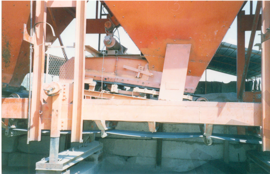
Gambar 4. Pintu Pengeluaran Agregat Dingin Dengan Sensor Timbangan Berat
