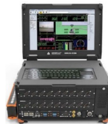
Gambar 7. Sistem akuisisi data mikrokomputer portabel. (Sumber: metromatics.com.au ).
