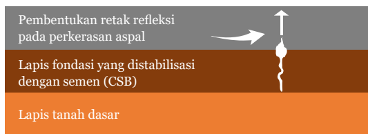
Gambar 4. Proses pembentukan retak refleksi pada lapis permukaan beraspal
