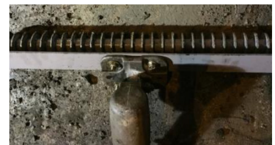
Gambar 6. Proses Perataan dan Pembentukan Alur Permukaan ( Grooving )
