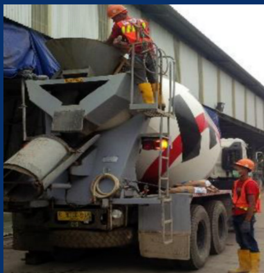
Gambar 4. Proses Pencampuran Di Dalam Truck Mixer
