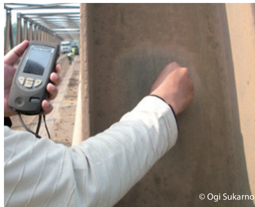
Gambar 13. Pelaksanaan Pengujian Ketebalan Galvanis Dengan Alat Ultrasonik
