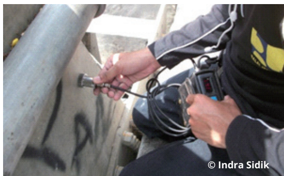
Gambar 12. Pelaksanaan Pengujian Ketebalan Pelat Baja Dengan Alat Ultrasonik
