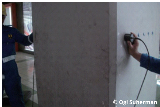
Gambar 8. Contoh Uji Kerapatan Beton
