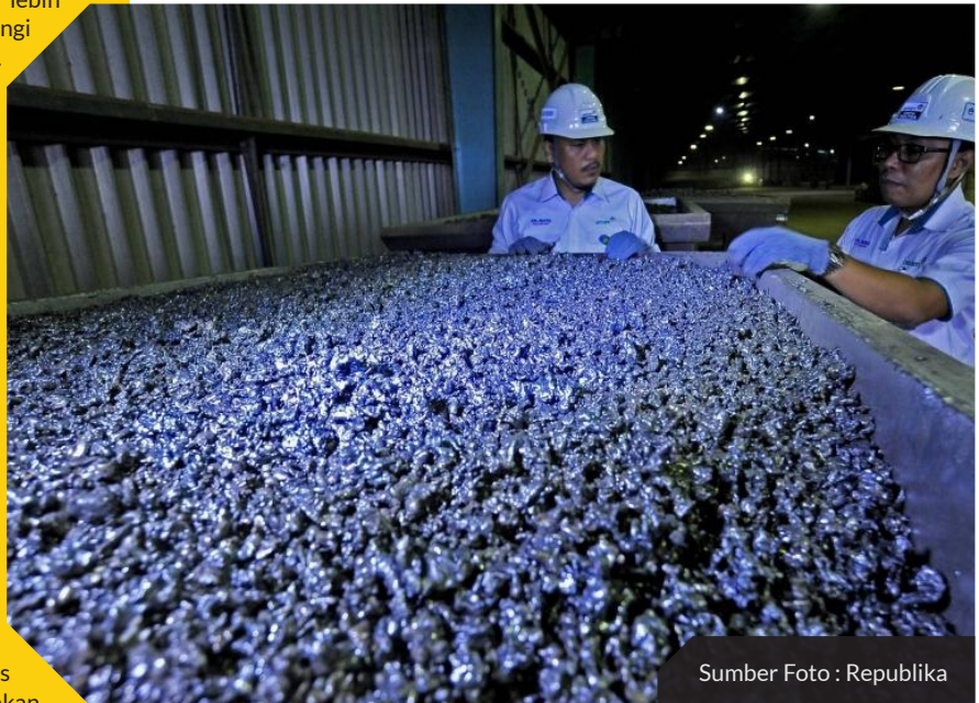
Gambar 2. Bentuk fisik limbah slag nikel
