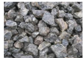
Gambar 4. Agregat limbah Slag baja dan pemanfaatan sebagai perkerasan campuran aspal
