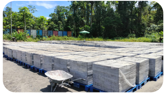
Gambar 10. Tailing untuk Batako Sumber: Limbah Tailing Freeport Dimanfaatkan Jadi Bata dan Paving Block - Pojok Papua
