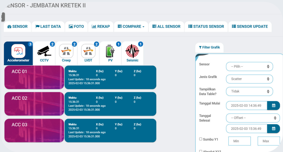
Gambar 16. Tampilan Dashboard SHMS Jembatan Krettek 2 (3) (PPK 1.2 Provinsi D.I. Yogyakarta, 2025)
