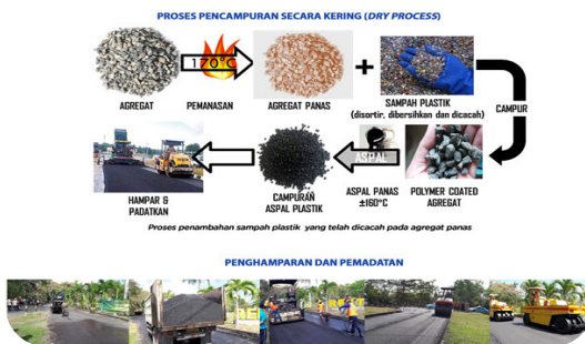
Gambar 5. Proses Pembuatan Aspal Plastik Sumber: https://binamarga.pu.go.id/balai-bahan-jalan/
